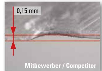
Die neuen G-Max Fräser sind mit einem der führenden Konkurrenten an einer 90-fachen Vergrößerung verglichen worden – der Unterschied der hergestellten Qualität ist deutlich zu sehen.
