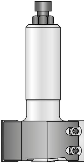
**HW-Wendeplatten-Füge- und Falz-Messerkopf Z2 + V2**
