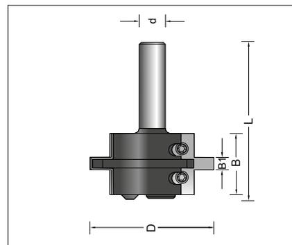
**Federfräser A/B / Tongue cutter A/B**
